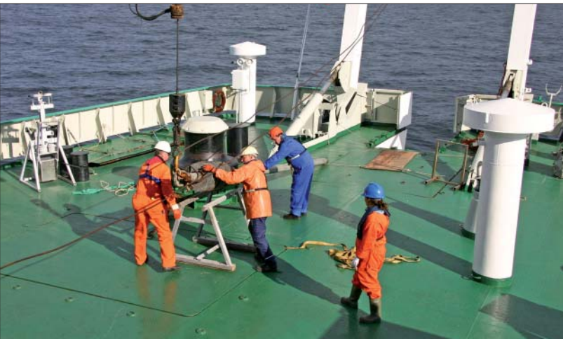
Til venstre: Tyngdekernetageren gøres klar til at blive sænket ned til havbunden under togt omkring Newfoundland med det russiske forskings-skib Akademik Loffe. (Foto: Esben Villumsen). Til højre: Kernestykkerne skæres op på langs og renses. Derefter beskrives sedimentet, og analyserne kan begynde. Den viste kerne er fra ca. 4.000 m's dybde i Anegade Jungfern Passagen og er indsamlet under Galathea 3-ekspeditionen. (Foto: Peter H. Kristensen)
