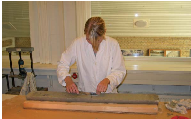
Til venstre: Tyngdekernetageren gøres klar til at blive sænket ned til havbunden under togt omkring Newfoundland med det russiske forskings-skib Akademik Loffe. (Foto: Esben Villumsen). Til højre: Kernestykkerne skæres op på langs og renses. Derefter beskrives sedimentet, og analyserne kan begynde. Den viste kerne er fra ca. 4.000 m's dybde i Anegade Jungfern Passagen og er indsamlet under Galathea 3-ekspeditionen. (Foto: Peter H. Kristensen)
