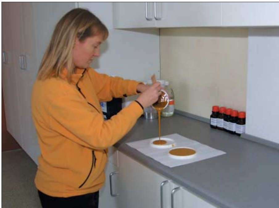
I produktudviklingen indgår en del laboratoriearbejde. Her laves der en prøve af en polyurethan-gulvbelægning, der blandt andet bruges i fødevarerindustrien eksempelvis mejerier og slagterier. (Foto: Jimmy Damgaard, Vesla, A/S)
