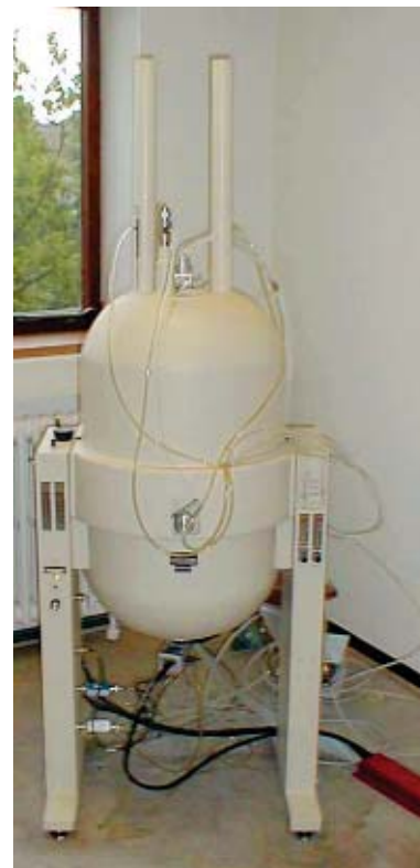
NMR-apparatet på Kemisk Institut, Aarhus Universitet. (Foto udlånt af lektor Steen Uttrup Pedersen, Kemisk Institut, AU)
