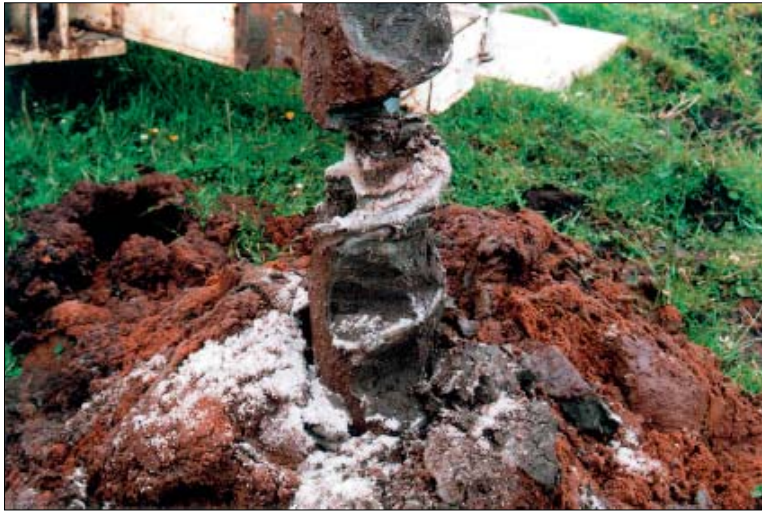
Ca. 10 cm tykt lag af tørt kvarttsand i 4, 6 meters dybde i det grå moræneler i boring B04. (Foto: Forfatteren)
