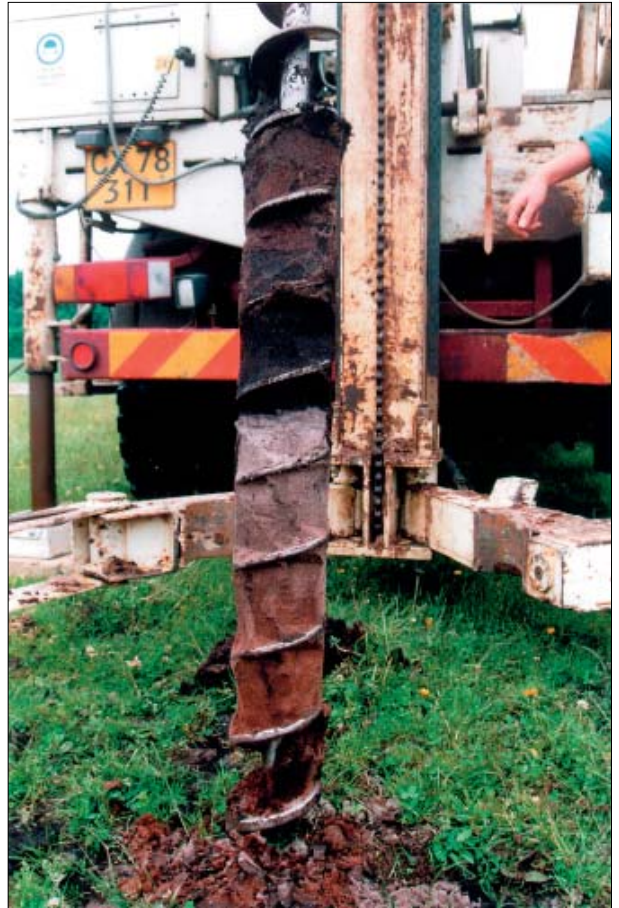
Ca. 10 cm tykt lag af tørt kvarttsand i 4, 6 meters dybde i det grå moræneler i boring B04. (Foto: Forfatteren)
