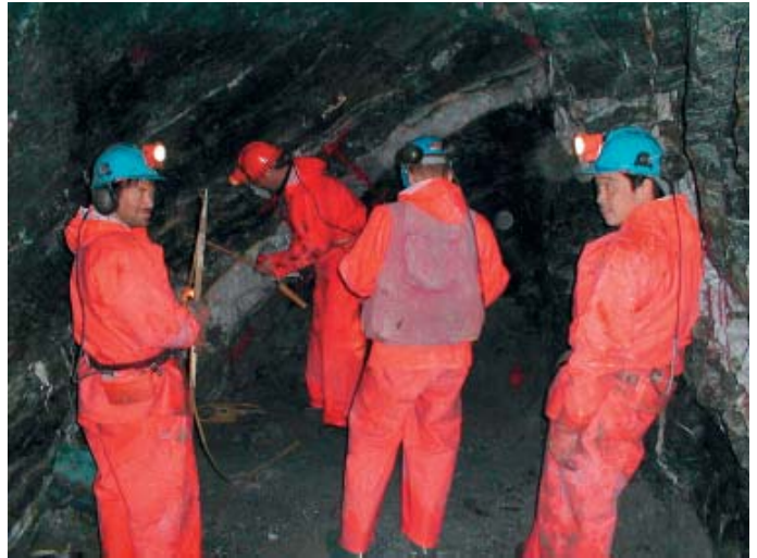
Geologer opmåler, kortlægger og undersøger kvartsåren for synligt guld. Herefter tages der prøver og fotograferes. Billedet viser en atypisk situation, for normalt er der kun én geolog og én assistent om jobbet. (Foto: Nalunaq I/S, J. Kyed)
