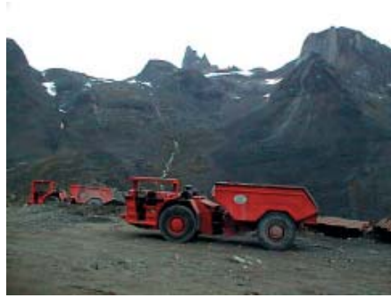
En dumptruck, som bruges til at transportere malm fra minen til malmlageret, kan transportere 15 t af gangen.
