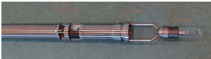
Videokamera til anvendelse i boringsundersøgelser. Kameraet kan holde til et vandtryk på 1500 m. (Foto: Anders Edsen)
