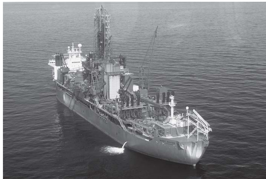
Billede af boreskibet West Navion, liggende ca. 140 km ud for Grønlands vestkyst. Boreskibet er 254 meter lang, 42 meter bredt og er udstyret med to rigge. (Foto: udlånt af Nunaoil A/S)
