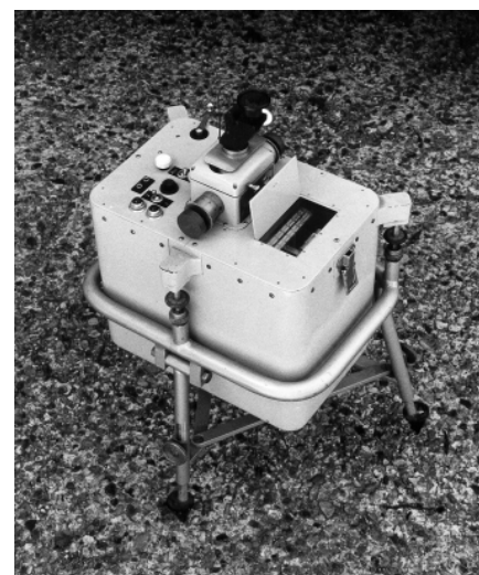
Dette gamle gravimeter blev lavet specielt til Geologisk Institut i Århus (Foto: Forfatteren)
