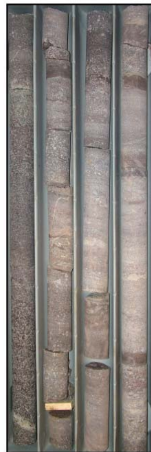
Ovenfor ses boringens placering (Foto: Arne Thorshøj Nielsen). Nedenfor til højre ses dele af borekernen fra Nedre Kambrium. (Foto: Forfatteren)
