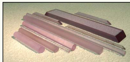
Nd^{3+}:YLF_4 Boule og laserstænger skåret fra boulen. (Fotos venligst udlånt af Northrop Grumman Directed Energy Systems)
