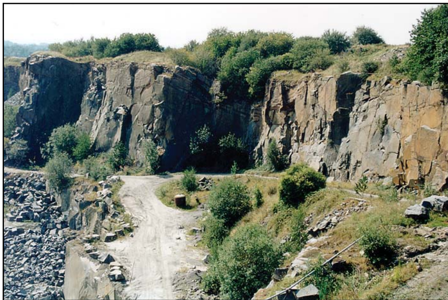
Blik ind i Klippeløkke-granitbrud, Bornholm, som er det største af de fem aktive danske brud, hvor man udvinder granit i blokke. Bruddet er over en halv km langt og op til 300 m bredt. (Foto: Forfatteren)
