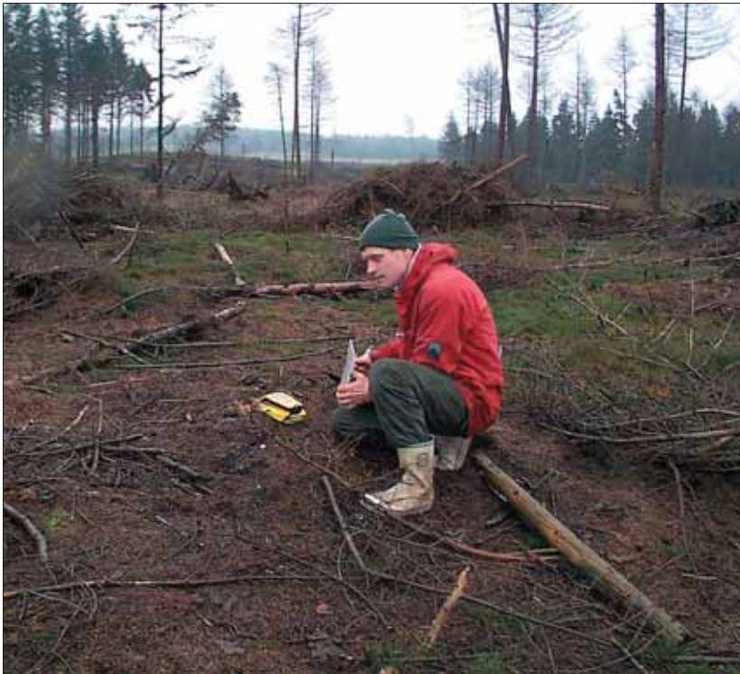
Jordbunds kortlægningens enkelte prøver beskrives i et skema for senere at blive tastet ind i en database. Stedfæstelsen sker med GPS (det gule instrument foran kartøren). (Foto: Eiler Mogensén, SNS)
