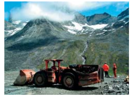
En scoop transporterer malmen fra tunnellerne til Dumptrucken. (Alle tre fotos: Nalunaq I/S, forfatteren)
