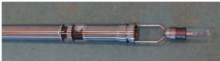
Videokamera til anvendelse i boringsundersøgelser. Kameraet kan holde til et vandtryk på 1500 m. (Foto: Anders Edsen)
