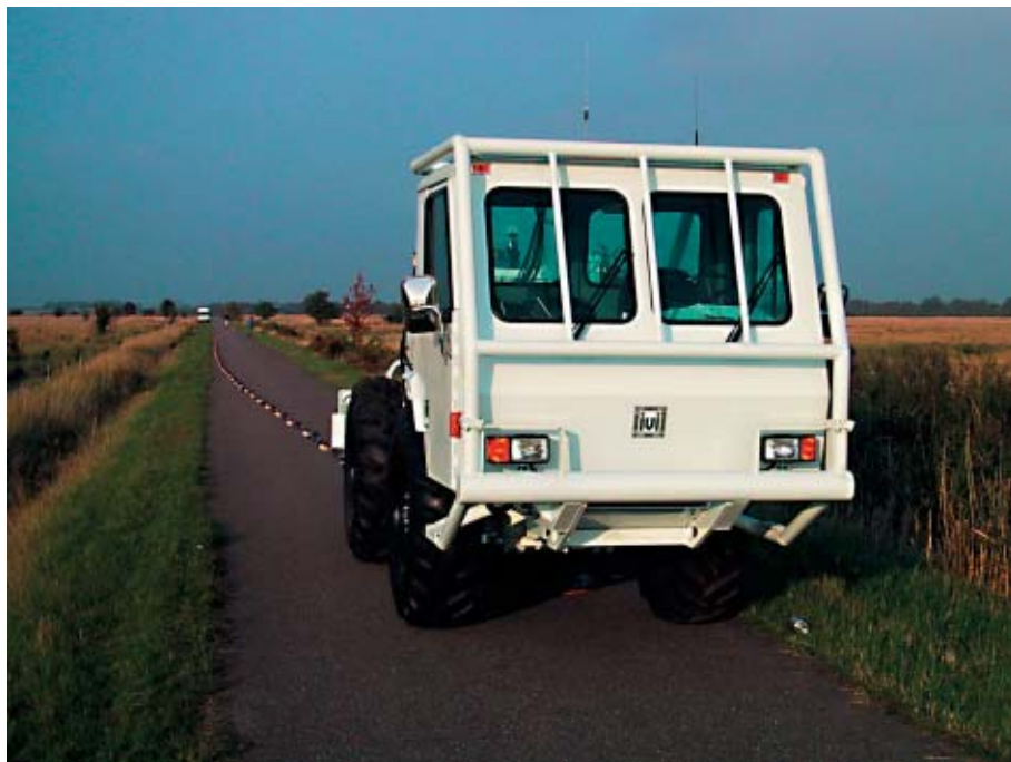
Den seismiske vibrator under slæbeseismisk arbejde på en lille asfaltevej. (Foto: Carsten Ploug)
