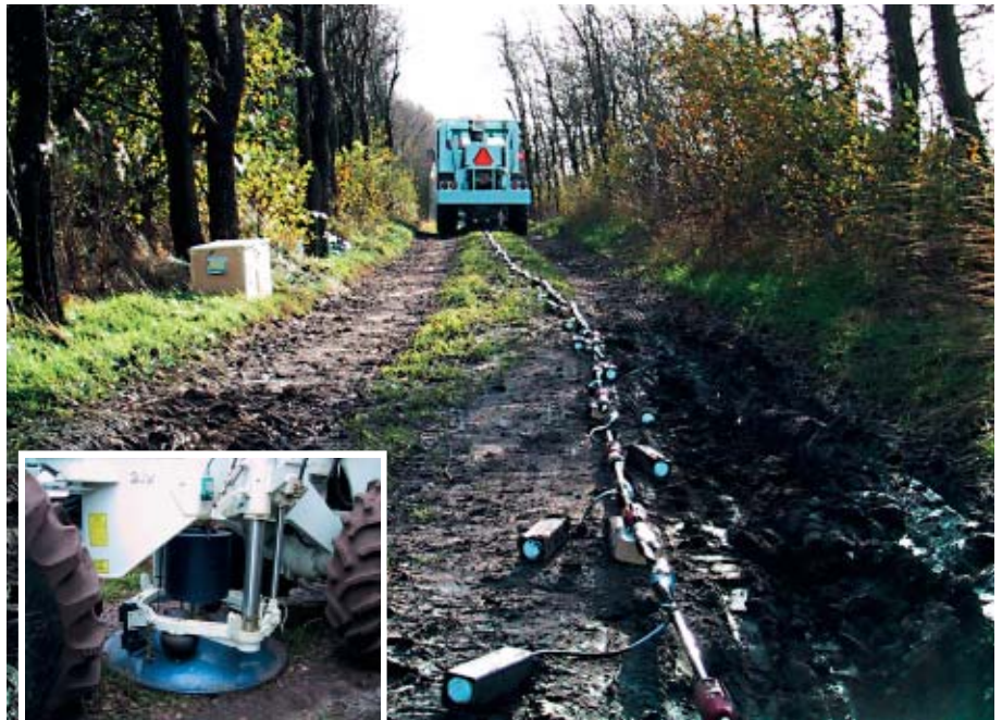
Undersøgelserne ved Vorbasse blev hovedsagelig udført på en lille jordvej. Vibrationerne overføres fra den seismiske vibrator til jordlagene via en vibratorplade (indsat foto), som bærer hele vibratorens vægt på ca. 7 ton, mens hjulene fungerer som støttehjul. (Foto: Henrik Olsen)
