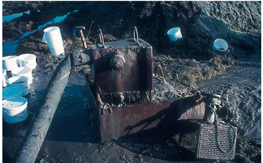
Prøvetagning ved Vollerup-boringen. Boringen er 216 m dyb. Der er taget prøver for hver meter. (Foto: Forfatteren)
