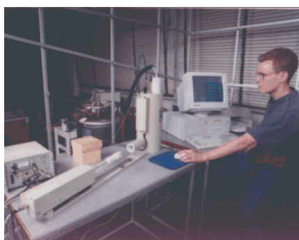
Minispin er et relativt billigt, men fintfølede apparat, som benyttes til måling af magnetisme i borekerner. (Foto: Molspin Ltd.)
