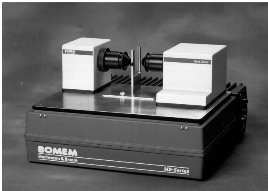
Et moderne IR-spektrometer er ikke en stor sag. Selve apparatet ligger i den grå kasse, og IR-lyset hentes op til prøven og igen ned til detektoren vha. spejle i de to tårne. (Foto: forfatteren)
